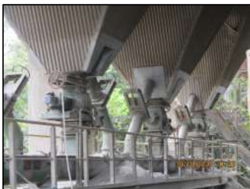
ภาพที่ 2.9 สายพานแบบปิดเพื่อลำเลียงฝุ่นจาก PH Boiler และ Preduster กลับสู่กระบวนการผลิต
