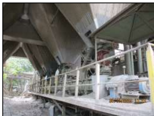
ภาพที่ 2.9 สายพานแบบปิดเพื่อลำเลียงฝุ่นจาก PH Boiler และ Preduster กลับสู่กระบวนการผลิต
